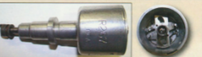
Remonter les rondelles de collage, le circlips et le toc.
