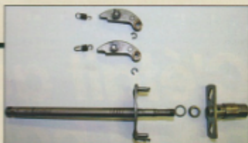
Dévisser la vis de blocage centrale et séparer l'axe des cames de l'axe d'entraînement. Démontez les 2 masselottes et leur ressort.
