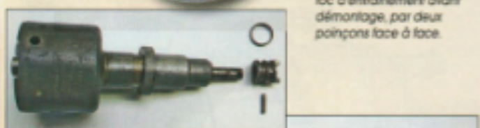
Chasse de la goupille du toc pour sortir l'axe d'entraînement.
