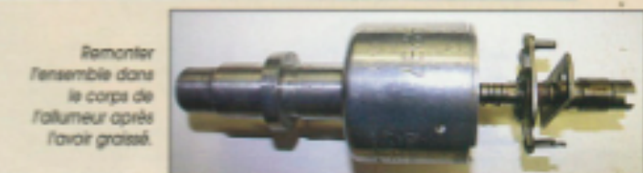
Remonter l'axe des cames sur l'axe d'entraînement, et les goupiller ensemble; remettre la vis centrale d'origine.
