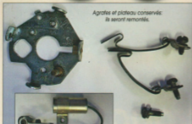
Condensateur et rupteur supprimés: ils ne seront pas remontés.
