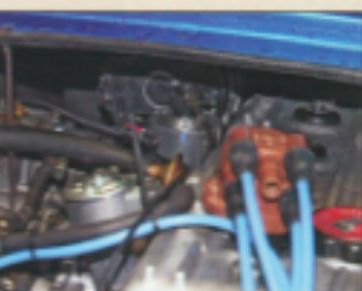
Tête d'allumeur ôtée, on aperçoit le disque en lieu et place des vis platinees. Tête en place, on ne voit rien si on a choisi de bien cacher le boîtier.
