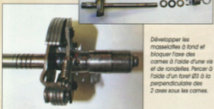
Tête d'allumeur ôtée, on aperçoit le disque en lieu et place des vis platinees. Tête en place, on ne voit rien si on a choisi de bien cacher le boîtier.
