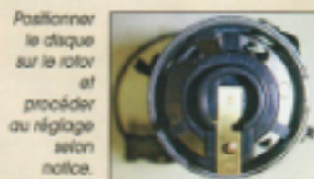
Remonter les rondelles de collage, le circlips et le toc.
