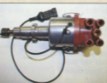
Remonter l'allumeur sur le moteur (en connectant les câbles HT selon l'ordre d'allumage 1-3-4-2).
